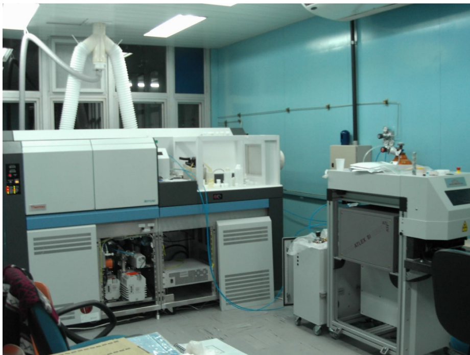
Figura 3 - Foto de LA - ICP - MS. Lado direito: fonte de laser de Photon Machine; lado esquerdo : ICP-MS modelo NEPTUNE.
