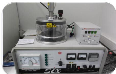
7- Recobrimento por deposição de íons de ouro (Au) em Metalizadora Scancoat -Six
